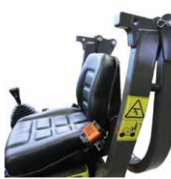
Structure ROPS pliable pour un transport facile
