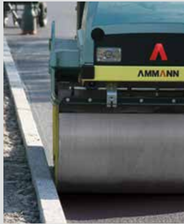
ARX2-4 – modèle avec décalage de billes
