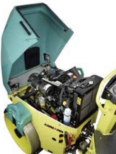
Accès facile à la machine grâce à l'important espace disponible une fois que le capot est ouvert – avantageux pour réaliser les opérations d'entretien
