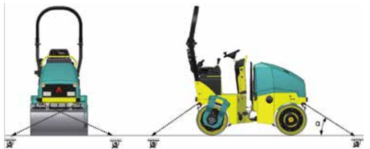
4 grands crochets permettant une fixation en toute sécurité sur la remorque/le camion
