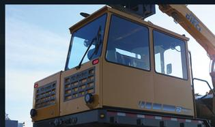
**Caractéristiques additionnelles** : système de commande CAN Bus, caméra de recul jour/nuit, communication radio prête pour la connexion, compresseur d'air.
