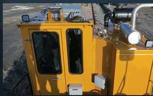
**Cabine entièrement fermée** avec vue sur 360° incluant un siège à dossier haut pivotant sur 180° pour une conduite bidirectionnelle automatique, la climatisation, le chauffage, un banc pour passager et un niveau sonore inférieur à 85 dBA offrant ainsi un maximum de confort et de sécurité à l'opérateur.
