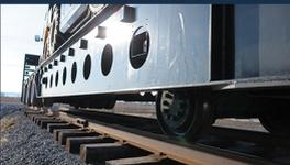
**Châssis unique** conçu spécialement pour offrir une capacité élevée (jusqu'à 120 000 lb – 54 545 kg) : parfait pour déplacer ou remorquer vers le chantier tous les types d'équipement tels qu'un camion malaxeur ou un camion-citerne à propane.
