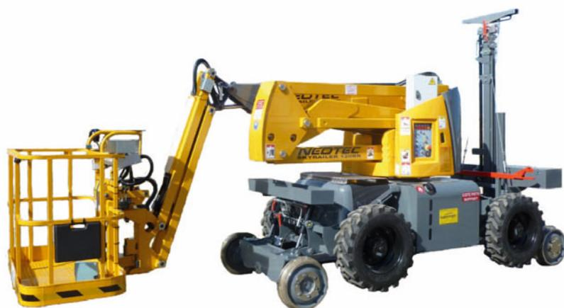
Le SKYRAILER 120RR est un engin polyvalent permettant d'évoluer sur différents types de réseaux ferrés (voie ferroviaire, tramway, métro).
