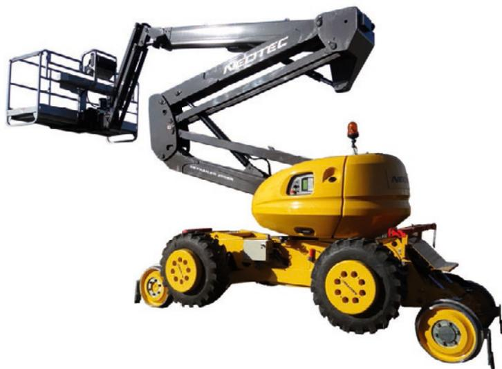
Le SKYRAILER 400RR a été développé par NEOTEC à partir de la nacelle Manitou série 160 ATJ +. Les essieux HI-RAIL EPV 14.32 NEOTEC garantissent la sécurité des utilisateurs dans toutes les conditions d'utilisation sur voie ferrée, en travail ou déplacement. Le SKYRAILER reste une machine extrêmement compacte tout en offrant de hautes performances, avec une charge utile dans le panier de 400 kg.
