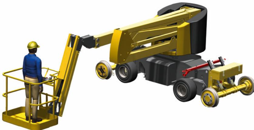
La nouvelle nacelle SKYRAILER E150RR, est la solutions Rail/Route Full Electrique idéale pour travailler dans des environnements fermés sans risque de rejets de particules et de gaz d'échappements nocifs à l'environnement. Sur une base de nacelle Haulotte HA15IP, la nacelle SKYRAILER E150RR est équipée d'essieux de guidage NEOTEC permettant un déplacement sur voies optimal.
